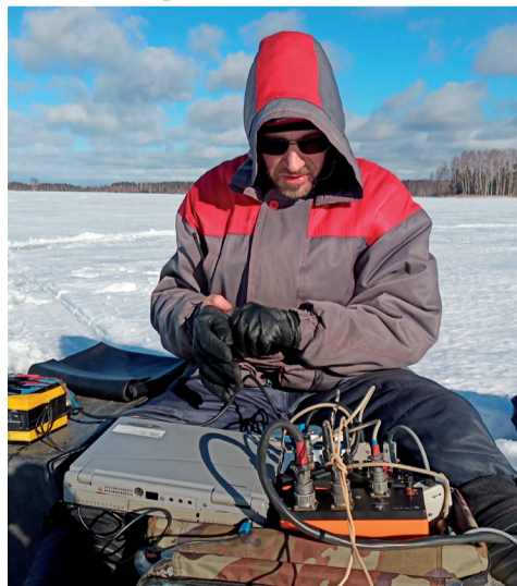
Электромагнитные зондирования методом переходных процессов на кольцевой структуре Бор-Тимонино в марте 2021 года
